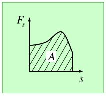
Рис. 2. Определение работы как площади фигуры под графиком  $F_s = f\left(s\right)$
