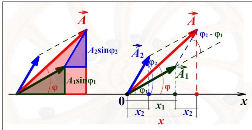
Рис. 1. К пояснению сложения гармонических колебаний одного направления и одинаковой частоты
