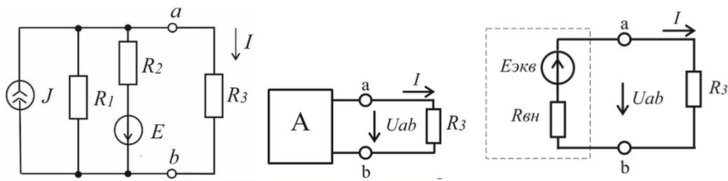
2) Заменяем активный двухполюсник эквивалентным генератором с ЭДС  $E_{экв}$  и внутренним сопротивлением  $R_{вн}$ .
